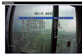
◆UTC 機能搭載 UTC 機能により同軸ケーブルのみでカメラの制御が可能です。 ※UTC 機能: BNC ケーブルの状態及び長さにより操作できない場合があります。 DVR で機能サポートが必要です。
