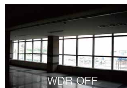
◆WDR 機能 WDR 機能により、逆光で発生する暗い領域の 明るさを調整し視認性を向上させます。
