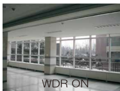
◆WDR 機能 WDR 機能により、逆光で発生する暗い領域の 明るさを調整し視認性を向上させます。
